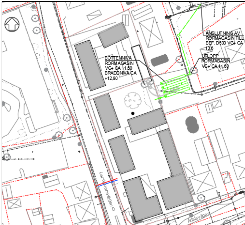
Bild 2: Avvattning norra fastigheten. Dagvattenhantering = gröna linjer.
