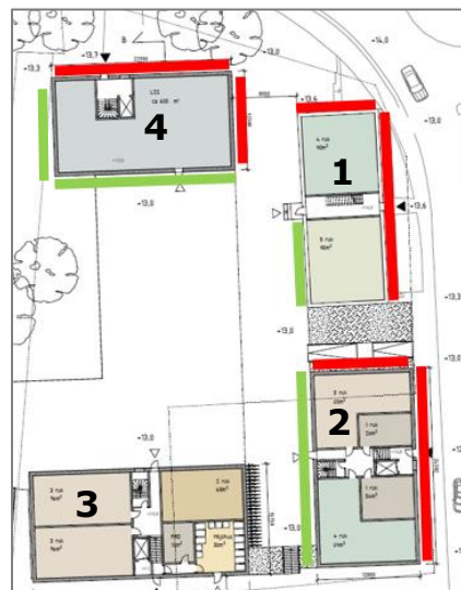
Figur 4 Utvärdering mot riktvärden vid byggnader på södra tomten. Röd markering innebär att riktvärdet 60 dBA överskrids vid fasaden. Grön markering innebär att kravet för ljuddämpad sida, 55 dBA ekvivalent ljudnivå och 70 dBA maximal ljudnivå innehålls.
